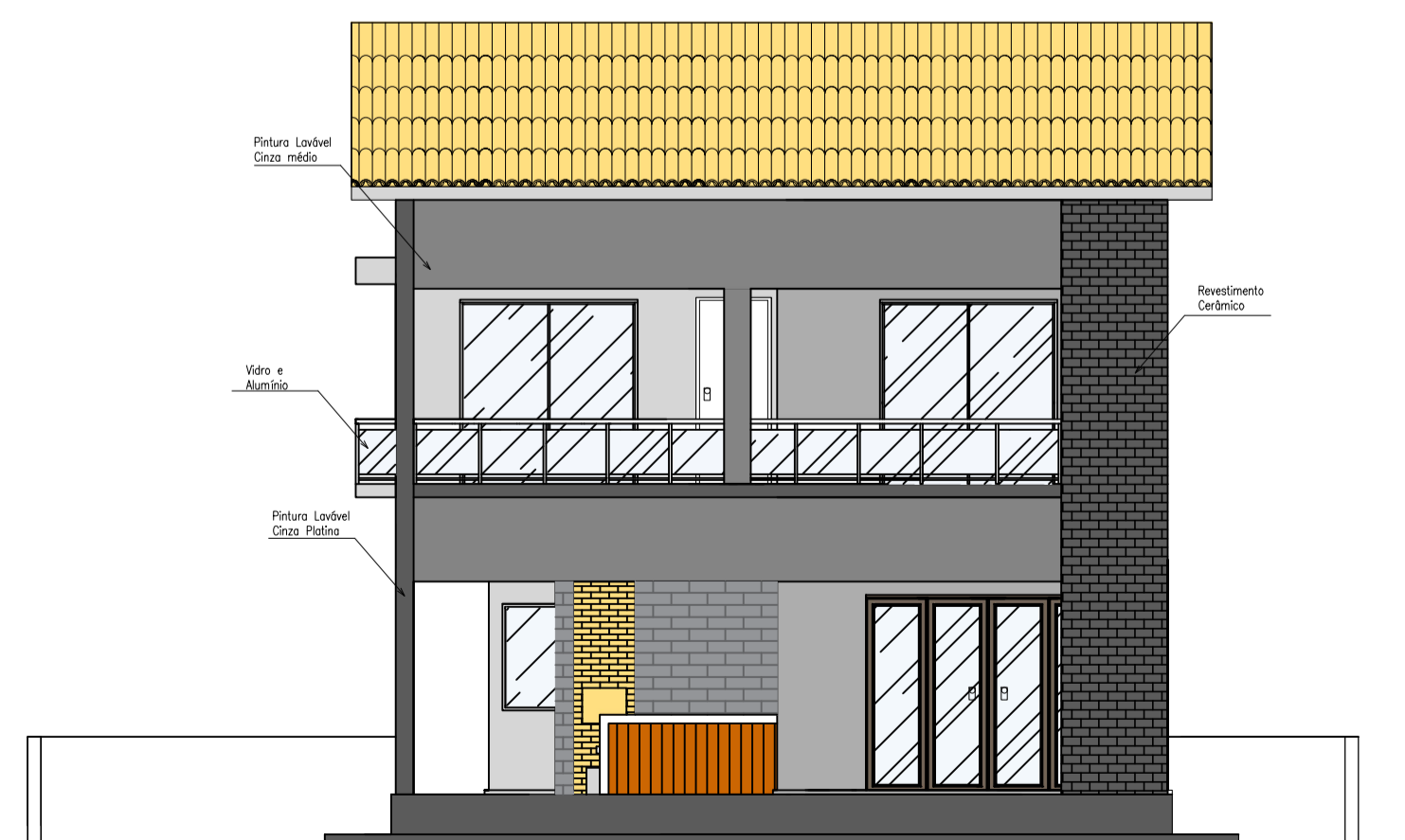
7 FACHADA NORTE RESIDÊNCIA — ESCALA: 1/75
